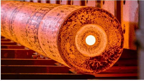
铠装机筒：14-400mm内径, 9m长度
